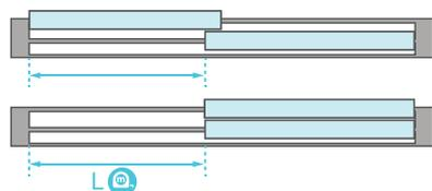
Na **altura**, deve medir a distância entre os caixilhos. Se a aplicação for interior, na **largura**, deve medir a distância entre o caixilho e o puxador da janela.
